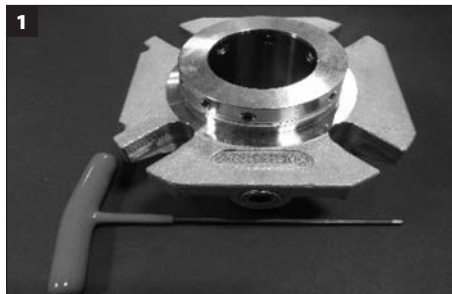
1 Værktøj, der er nødvendigt til demontering af tætning: Sekskantnøgle (vedlagt tætningen); pincet og en buet spidsmejsel (kunden sørger selv for dette; til fjernelse af O-ringe og drivrør).
