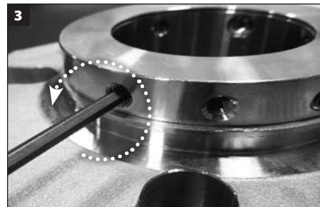
3 Fjern alle skruer med cylindrisk ende og 1/4 stilleskruer fra låseringen og bortskaf.
